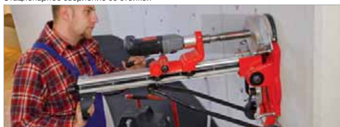
Стационарное сверление со стойкой
